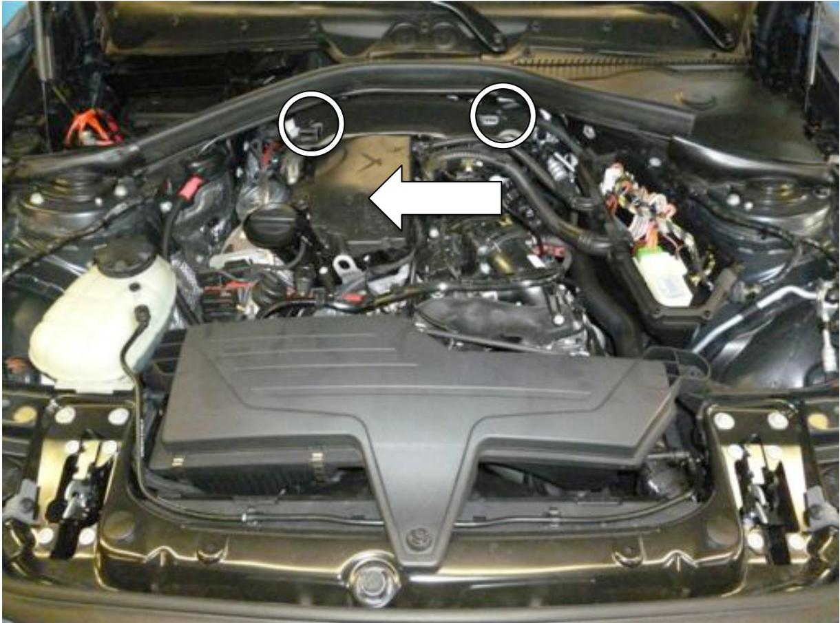
Die Dämmmatte und die Clipse entfernen.
